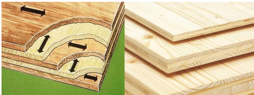
تخته‌های چند لایه و لایه‌های عمود بر هم آن
