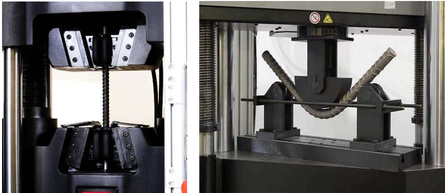
نمونه آزمایش خمش و کشش میلگرد
